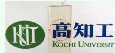
超微細均一TiO<sub>2</sub>ナノロッド薄膜の透明性
